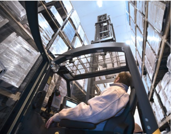
Cabina opcional equipada con tejadillo protector transparente con malla metálica de protección.
