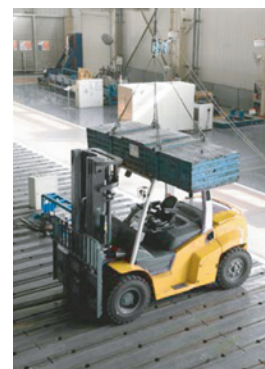
Ensayo de impacto de la estructura de protección superior
