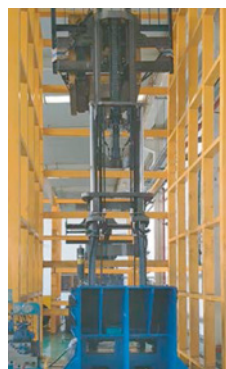
Ensayo de fatiga del sistema de elevación
