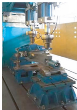
Ensayo de fatiga del eje motriz
