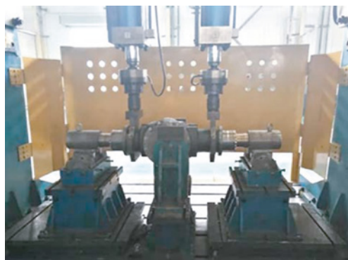
Ensayo de fatiga del eje de dirección
