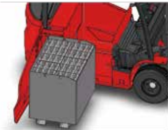
Lateral de la batería que se quita con las horquillas (opcional)
