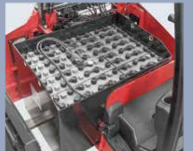
El desalojo lateral de la batería proporciona una solución rápida, simple y segura para el operador
